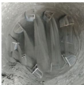
Рис. 1. Образец фото для определения степени заполнения поперечной поверхности барабана
