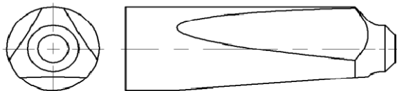
Рис. 2. Поршень предохранительного клапана фирмы Бош [1]
