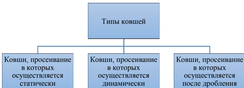
Рис. 1. Основные группы сортировочных ковшей одноковшового гидравлического экскаватора
