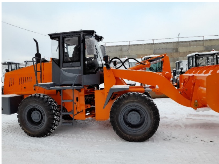
Рис. 1. Погрузчик фронтальный ДМ-30 с ковшем [2]
