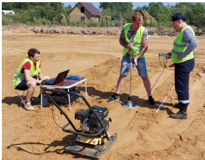
Рис. 1. Экспериментальные исследования уплотнения грунта виброплитой ZITREK CNP-20
