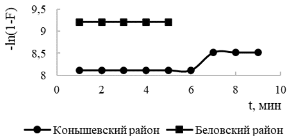
Рис. 1. Зависимость \ln(1 - F) от t сорбции ионов Zn (II) карбонатными породами, модифицированными раствором HCl
