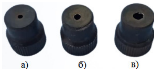
Рис. 1. Общий вид сопла распылительной форсунки: a - d_{ин} = 1 \text{ мм} ; б - d_{ин} = 2 \text{ мм} ; в - d_{ин} = 3 \text{ мм}
